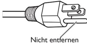
Dieses Gerät hat einen dreipoligen geerdeten Stecker. Entfernen Sie den Erdungskontakt nicht. Aus Sicherheitsgründen passt dieser Stecker nur in eine geerdete Steckdose. Wenden Sie sich an den Elektriker, wenn der Stecker nicht in die Steckdose passt.
