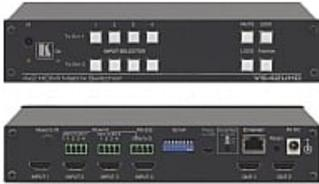
La VS-42UHD est une grille de commutation haute performance 4x2 pour les signaux HDMI 4K@60Hz (4.2.0). Il reclocke et égalise les signaux et peut commuter toute entrée vers une ou deux sorties simultanément
