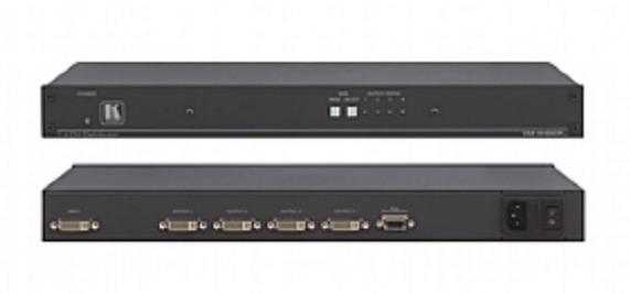
VM-4HDCPxI ist ein HDCP-konformer Verteilverstärker für DVI-D Signale mit Auflösungen bis zu 1080p oder WUXGA. Er nimmt ein Eingangssignal entgegen und verteilt das Signal neugetaktet und entzerrt an vier identische Ausgänge.
