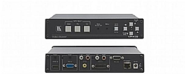
VP-439 ist ein digitaler Hochleistungsscaler für Computergrafikvideo, Comp.Video und HDMI einschl. Audio. Er skaliert das gewählte HDMI-, CV- oder Computergrafik-/YPbPr Signal auf- oder abwärts und gibt es als HDMI am DVI-I Ausgang aus.
