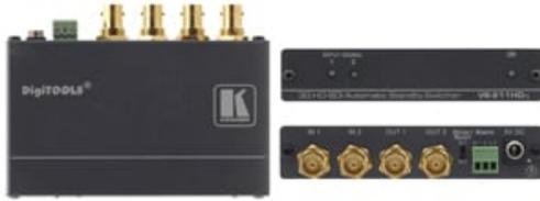
Le VS-211HDxl est un sélecteur automatique haute performance pour signaux 3G HD-SDI. Lorsqu'il est configuré comme sélecteur de sécurité en veille, le VS-211HDxl se commute automatiquement sur l'entrée secondaire lorsque l'entrée primaire est défailante
