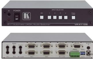
Le VP-411DS est un sélecteur haute performance pour signaux informatique graphique avec des résolutions de VGA à UXGA et plus, et audio stéréo asymétrique. Lorsqu'il est configuré en sélecteur automatique, la priorité peut être déterminée pour chacune des quatre entrées
