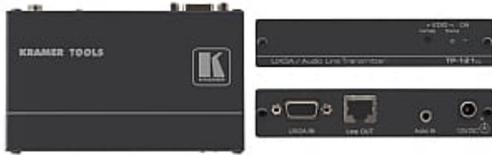
Le TP-121xl est un émetteur sur paires torsadées haute performance pour signaux VGA et audio stéréo asymétrique. Il convertit les signaux en entrée en signal paires torsadées puis transmet les signaux sur câble CAT5 à un récepteur compatible
