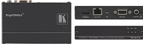
Le TP-573 est un transmetteur de signaux HDMI, RS-232 bidirectionnel et infrarouge transmis sur paire torsadée. Le Kramer TP-573 convertit les signaux d'entrée au format paire torsadée et le récepteur TP-574 les retransforme en signaux HDMI, RS-232 bidirectionnel et infrarouge
