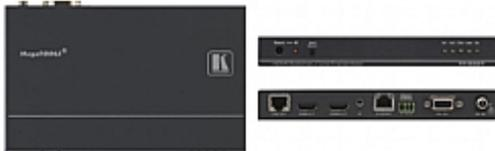
TP-582T ist ein hochwertiger Twisted Pair Übertrager für HDMI-, Ethernet 100BaseT-, bidirektionale RS-232 und IR-Signale. Er wählt einen von zwei HDMI-Eingängen aus und wandelt dieses Signal zusammen mit den Ethernet 100BaseT-, RS-232- und IR-Eingangssignalen in ein Twisted Pair Signal. Der TP-582R wandelt das Twisted Pair Signal zurück in die Ausgänge für Ethernet 100BaseT, RS-232, IR und zwei HDMI. Außerdem koppelt er Audio aus und gibt es als S/PDIF und TOSLINK® aus.
