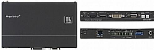
SID-X2N ist ein Multi-Format HDBaseT Twisted-Pair Übertrager mit 4 Signaleingängen für Computergrafikvideo (VGA), HDMI, DVI und DisplayPort mit "Step-in" Auswahltaste. Das Modul verfügt über eine automatische Erkennung des verwendeten Signaleingangs. SID-X2N unterstützt sowohl digitales Embedded-Audio als auch die Einspeisung von analogen Stereo-Audio Signalen. Die Umschaltung zwischen den verschiedenen lokalen Signaleingängen kann auch über einen Kontakteingang ausgelöst werden.
