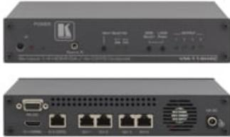
Le VM-114H4C est un sélecteur et distributeur amplificateur haute performance pour signaux HDMI et paires torsadées (DGKat). Il reclocke et égalise un des deux signaux d'entrée (HDMI ou paires torsadées) puis le distribue vers quatre sorties paires torsadées (DGKat)
