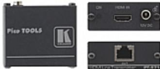
Der Kramer PT-571 ist ein Twisted Pair Übertrager für HDMI-Signale. Der PT-571 konvertiert das HDMI-Signal in ein Twisted Pair Signal und überträgt dieses über eine einzelne Twisted Pair Leitung an einen kompatiblen Empfänger z.B. PT-572 oder PT-572+. Der Empfänger wandelt das eingehende Twisted Pair Signal zurück in ein HDMI-Signal.
