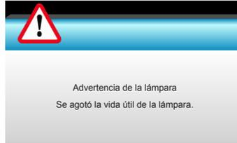
Cuando aparezca este mensaje, póngase en contacto con su distribuidor local o con el centro de servicio local para cambiar la lámpara tan pronto como sea posible. Asegúrese de que el proyector se ha enfriado durante al menos 30 minutos antes de cambiar la lámpara.
