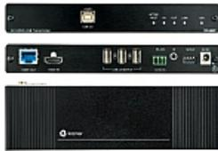
TP-590T ist ein Hochleistungs-Transmitter mit HDBaseT 2.0-Technologie für 4K60Hz (4:2:0) HDMI-, USB-, RS-232-, and IR-Signale über CAT-Kabel. TP-590T wandelt alle eingehenden Signale in HDBaseT 2.0-Signale um und überträgt diese an den Empfänger TP-590R. Video-Signale werden bei 4K@60Hz (4:2:0) 24bpp über CAT-Kabel um bis zu 40m übertragen. Für Full-HD-Signale gilt eine längere Reichweite
