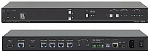
VM-214DT ist ein 4K UHD Verteilverstärker für HDMI und HDBaseT Signale. Das Eingangssignal wird neu getaktet und entzerrt und an vier identische HDBaseT Ausgänge und den HDMI-Loop-Ausgang verteilt. Das Gerät unterstützt Auflösungen bis 4K @60 Hz (4:2:0) UHD. Der VM-214DT bietet eine Vielzahl von Steuerungs-Optionen sowie lokale Audio-Auskopplung mit Lautstärkeregelung.
