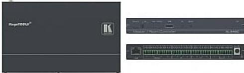
SL-240C ist eine kompakte Master-Raumsteuerung (Kramer Control Brain) mit PoE. Das Gerät arbeitet über Ethernet mit folgenden Steuer-Schnittstellen: vier bidirektionale RS-232, vier IR, vier GP I/O und vier Relais. Es steuert Geräte wie z.B. Scaler, Videodisplays, Audioverstärker, Blu-Ray Spieler, Sensoren, Bildwände, Vorhänge, Türverriegelungen und Beleuchtung. Mehrfache Kramer Ethernet Steuer-Gateways können für weitere I/O Ports verwendet werden
