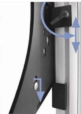
Schrauben Sie jetzt die 4 Schrauben an den dafür vorgesehenen Stellen in ihr Display. Danach können Sie das Display kinderleicht in die VESA Halterung einhängen, indem Sie die Schraubenköpfe durch die Öffnung stecken und danach das Display absenken. Zur Sicherheit können Sie jetzt noch einmal die Schrauben nachziehen.
