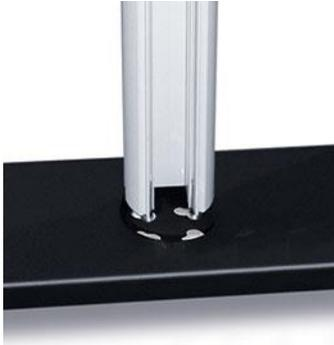
Verbinden Sie als erstes mithilfe des Bajonett-Schraubverschlusses das Alu-Profilrohr mit dem Standfuß. Stecken Sie hierfür die ins Rohr eingeschraubten Schrauben in die dafür vorgesehene Öffnung im Fuß, drehen Sie das Rohr im Uhrzeigersinn bis es anschlägt und ziehen Sie dann die Schrauben von unten am Fuß fest.
