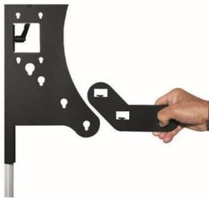
Um die VESA Halterung mithilfe des Erweiterungssets auf eine VESA 600x400 zu erweitern, müssen Sie die einzelnen Erweiterungsschienen wie auf dem Bild zu sehen in die vorhandenen Löcher der VESA Halterung einhängen. Achten Sie hierbei besonders darauf, dass die Schienen komplett eingehängt sind und die Löcher wie auf dem Bild die größere Öffnung oben haben, Danach können Sie wie gewohnt Ihr Display montieren.
