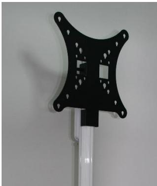
Jetzt können Sie die VESA Displayhalterung von oben in das Alu Profilrohr schieben. Versichern Sie sich, dass die VESA Halterung in der richtigen Position montiert wird und schieben Sie dann beide Winkel in die T-Nuten des Rohrs. Befestigen Sie dann die Halterung in beliebiger Höhe mit den Klemmhebeln. Bringen Sie jetzt die Abdeckklappe oben an dem Rohr an.
