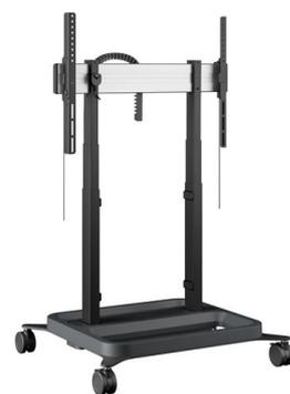
Der motorisierte Display-Liftwagen RISE 5305 eignet sich für Displays bis zu 86" mit einem maximalen Gewicht von 120 kg. Der Lift hebt das Display sanft, schnell und sicher mit einer Geschwindigkeit von 50 mm/s mit QuickRise™ an. Mit einem Hubbereich von 980 mm ist der Lift sowohl für sehr niedrige als auch für hohe Positionen geeignet.
