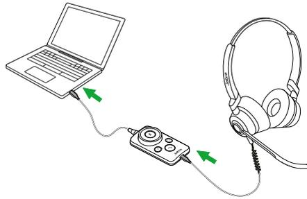
**Utilisation de l'unité de commande disponible en option :** Il suffit de brancher le casque sur l'unité de commande, puis de brancher l'unité de commande sur l'ordinateur. Des versions USB-A et USB-C du contrôleur sont disponibles.
