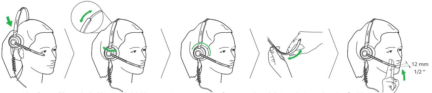
Les casques Jabra Engage 50 sont dotés d'écouteurs réglables garantissant un grand confort tout au long de la journée. La perche micro flexible et rotative sur 300° autorise un réglage facile sans risque de cassure. Pour une position optimale, le microphone doit se trouver à 12 mm de la bouche.
