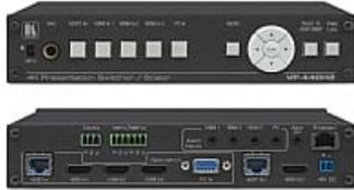
Le VP-440H2 est un sélecteur/scaler de présentation 4K@60Hz (4:4:4) avec une entrée HDBaseT/POE, trois entrées HDMI et une entrée VGA. L'équipement redimensionne la vidéo, embedde l'audio et produit le signal vers une sortie HDMI et une sortie HDBaseT simultanément. L'unité comprend des entrées et des sorties audio analogiques et embeddées
