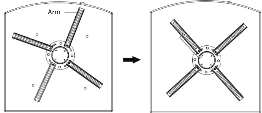
Platzieren Sie die Projektor Aufnahmeplatte E so weit wie möglich in die Mitte vom Schwerpunkt des Projektors. Positionieren Sie nun die Löcher der Arme über die Montagelöcher.
