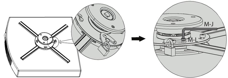
Nutzen Sie das Vorhängeschloss, um den Projektor vor unbefugter Demontage zu Schützen. Fixieren Sie den Bügel für das Vorhängeschloss mit einer Schraube.
