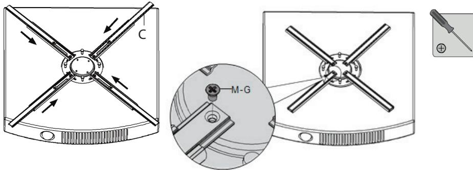
Schieben Sie die Sicherheitsabdeckungen C in die Arme der Projektor Aufnahmeplatte E
