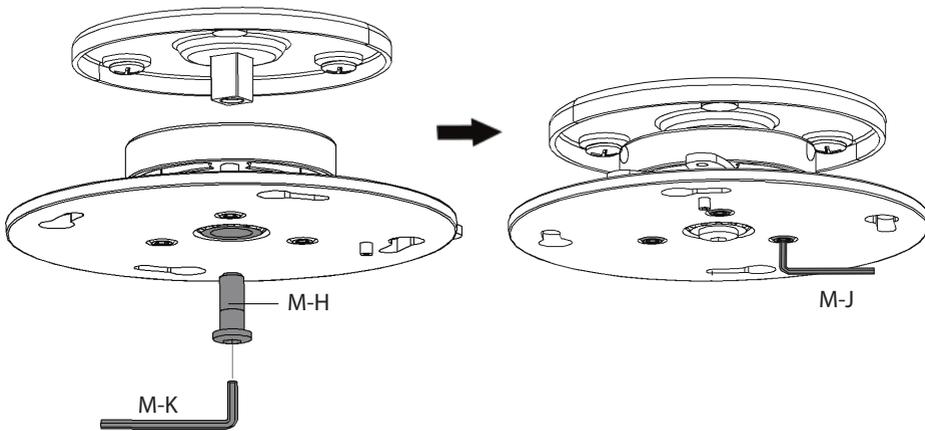
Montieren Sie die Adapterplatte B an die Deckenplatte A mit den bereitgestellten Schrauben
