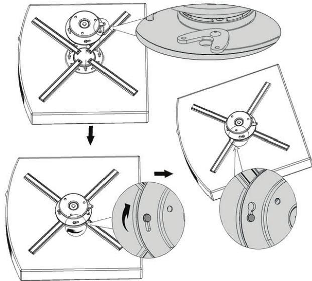
Führen Sie die Projektor Aufnahmeplatte E vorsichtig mit den Schrauben in die Öffnungen der Adapterplatte B und drehen die Projektor Aufnahmeplatte E vorsichtig im Uhrzeigersinn.
