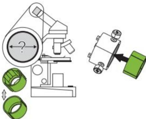
2. Befestigen Sie den Mikroskopadapter an der Dokumentenkamera und ziehen Sie die drei Schrauben fest, bis der Adapter gesichert ist.
