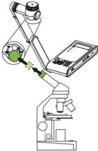
4. Drehen Sie den Mikroskopadapter gegen den Uhrzeigersinn, um die Pfeile auszurichten, und verriegeln Sie den Mikroskopadapter.
