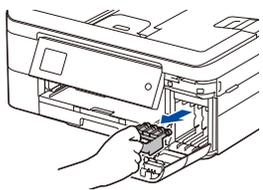
Öffnen Sie die Tintenpatronen-Abdeckung und entfernen Sie den orangefarbenen Transportschutz vom Gerät.
