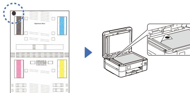
Folgen Sie den Anweisungen auf dem Display, um die Seite für die Druckanpassung zu drucken. Die schwarze Kreismarkierung befindet sich oben links auf der Seite.
