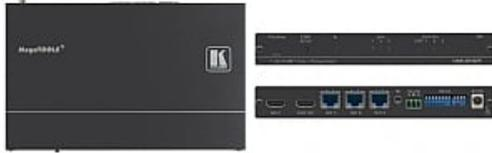
Le VM-3HDT est un extenseur HDBaseT 1:3 de haute qualité qui prend une entrée HDMI, avec des signaux de contrôle IR et RS-232, la convertit vers un signal ligne d'extension HDBaseT et le distribue sur trois sorties HDBaseT qui se connectent à un récepteur compatible HDBaseT tel que le TP-580R. Le VM-3HDT distribue les signaux avec des résolutions allant jusqu'au 4K@60Hz (4:2:0) et inclut une sortie HDMI LOOP pour la connexion d'une unité supplémentaire en daisy chain
