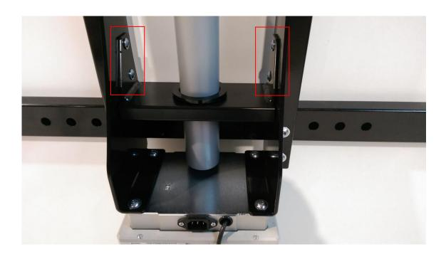
4x Allen head lens screw with flange M6x12 Linsenkopfinbusschraube mit Flansch
