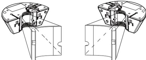
2. Verbinden Sie die beiden Lautsprecher durch die Metallklammer, so dass die Halterung umschlossen wird.
