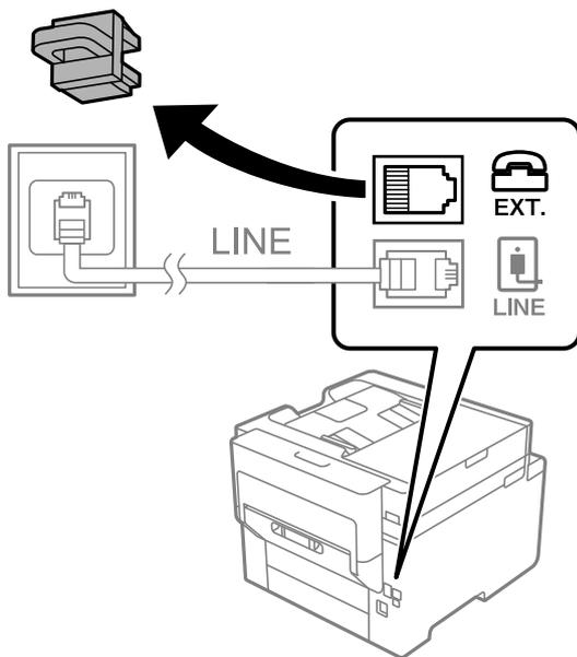
2. Verbinden Sie den Telefonapparat über ein Telefonkabel mit dem EXT.-Anschluss.
