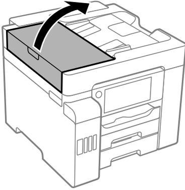
2. Reinigen Sie die Rolle und die Innenseite des ADF mit einem weichen, feuchten Tuch.
