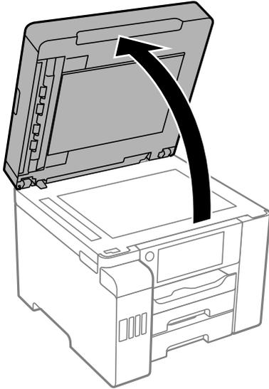
2. Reinigen Sie die Oberfläche des Vorlagenglases mit einem weichen, trockenen, sauberen Tuch.
