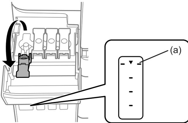
8. Richten Sie die Tintenflasche oben am Fülleinlass aus und setzen Sie sie dann direkt in den Einlass ein, um die Tinte bis zur oberen Linie aufzufüllen.
