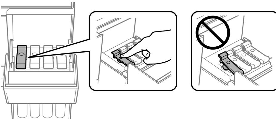
12. Schließen Sie die Tintenbehälterabdeckung sicher.
