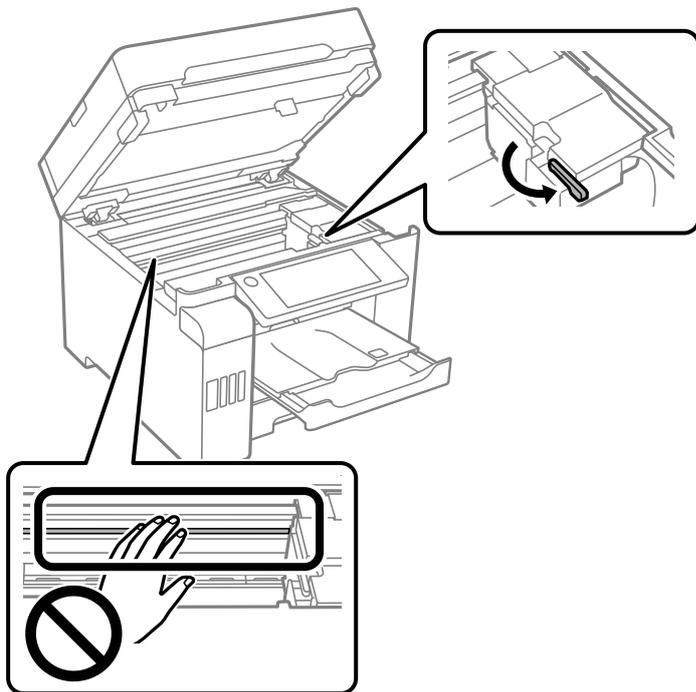
9. Sichern Sie den Druckkopf mit Klebeband am Gehäuse.
