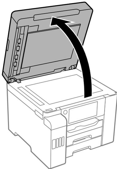
4. Reinigen Sie den in der Abbildung angezeigten Bereich.
