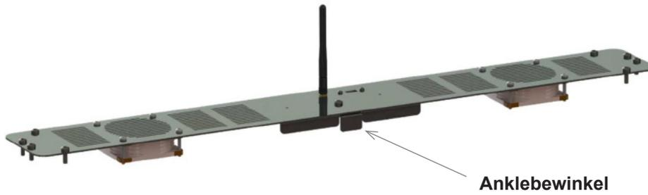
Die Folie des Anklebewinkels abziehen. Den Deckel wieder komplett montieren. Die Schraube des Anklebewinkels lösen und den Winkel an die Rückseite der Front andrücken und festschrauben.
