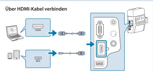
Wenn Sie ein dickes HDMI-Kabel verwendet, kann sich dies durch sein eigenes Gewicht lösen. Fixieren Sie das Kabel mit einer HDMI-Kabelklemme.
