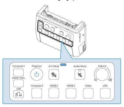
Drücken Sie die Eingangsquellentasten zur Eingabe von Bildern und Ton von dem mit dem Anschluss verbundenen Gerät; beachten Sie die nachstehende Tabelle. Das Umschalten der Quelle kann eine Weile dauern.
