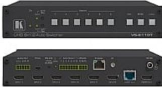
Le VS-611DT est un sélecteur automatique pour les signaux vidéo HDMI avec une résolution jusqu'à 4K@60Hz (4:2:0). Avec 6 entrées HDMI, il peut commuter manuellement ou automatiquement sur une entrée prédéfinie ou sur la dernière entrée connectée chaque fois que le signal vidéo actif est interrompu ou lorsqu'un signal vidéo prioritaire est introduit. Le signal de sortie est distribué vers des sorties HDBaseT et HDMI 4K@60Hz (4:2:0)
