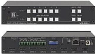
La VS-62H est une grille de commutation 6x2 haute performance pour signaux HDMI. Elle reclocke, égalise les signaux et commute l'entrée vers l'une ou l'autre ou les deux sorties simultanément. Elle supporte des résolutions allant jusqu'à 4K@60Hz (4:2:0) UHD et WUXGA
