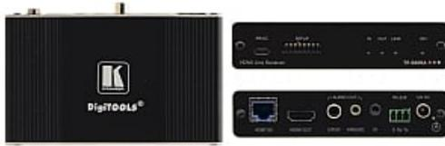
Le TP-580RA est un récepteur HDBaseT pour les signaux HDMI 4K@60Hz (4:2:0), RS-232, IR et audio stéréo sur paires torsadées qui désempede le signal audio stéréo sur ses ports audio analogiques et numériques. Il étend les signaux vidéo jusqu'à 40m (130ft) sur des câbles en cuivre CAT avec une résolution vidéo allant jusqu'au 4K@60Hz (4:2:0) 24bpp. Il fournit un déport plus long pour les résolutions vidéo HD inférieures
