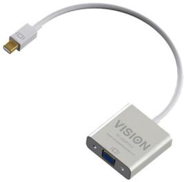
Anschluss an Mini-DisplayPort (auch bekannt als Thunderbolt), mit VGA-Buchse. Aktive Schaltung wandelt bei Geräten, die keinen Digitaleingang haben, das digitale Signal in ein analoges VGA-Signal um.
