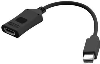
Anschluss an Mini-DisplayPort (auch bekannt als Thunderbolt),mit HDMI-Buchse in voller Größe. Aktive Schaltung gestattet das Anschließen von PCs mit oder ohne Dual-Mode-DisplayPort (DP++) an Anzeigegeräte mit HDMI-Eingang.
