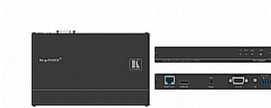
TP-780T ist ein Twisted Pair Übertrager für HDMI, bidirektionales RS-232 und IR. Er unterstützt Auflösungen bis 4K @60 Hz (4:2:0) UHD. Das Gerät wandelt HDMI, RS-232 und IR-Signale in ein TP-Signal und überträgt dies an einen Empfänger z.B. TP-780R, der das TP-Signal wieder zurück in 4K HDMI, bidirektionales RS-232 und IR wandelt. Dabei ist die Übertragungsreichweite 40 m über Kupferkabel, bei geringerer Auflösung auch darüber hinaus. Der TP-780T unterstützt PoE.
