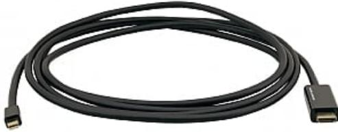
Le C-MDP/HM/UHD de Kramer vous permet de connecter votre PC ou ordinateur portable équipé du Mini DisplayPort™ à un écran HDMI sans adaptateur ni câble supplémentaire requis. Ce câble Mini DisplayPort vers HDMI actif est utilisé pour une véritable conversion lorsque la source ne prend pas en charge le DP++ et peut être utilisé avec les sorties DisplayPort mono-mode ou Dual-mode. C-MDP/HM/UHD prend en charge une résolution vidéo jusqu'à 4K@60 (4:4:4) et HDCP 2.2
