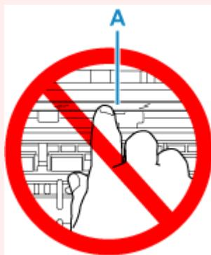
**Der Drucker kann beschädigt werden, wenn Sie dieses Teil durch Papier- oder Handberührungen verunreinigen oder zerkratzen.**
