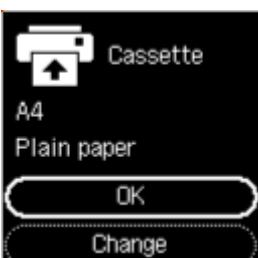
Wenn das Seitenformat auf der LCD-Anzeige mit dem Format des in die Kassette eingelegten Papiers übereinstimmt, wählen Sie **OK** aus.
