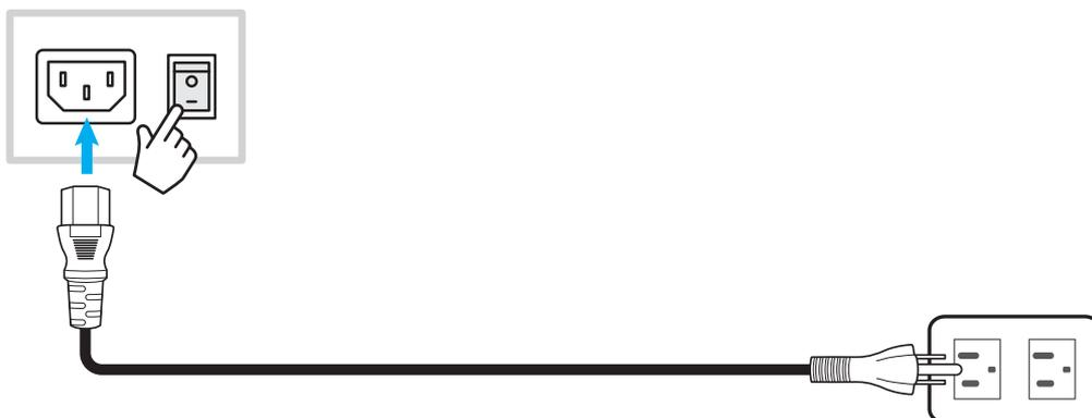
Drücken Sie zum Einschalten des IFP die **Stromversorgung**. Die LED-Anzeige wird weiß, was anzeigt, dass das Gerät einsatzbereit ist.
