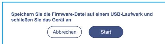
**Hinweis:** Wenn Sie die Firmware des IFP über ein USB-Laufwerk aktualisieren, dekomprimieren Sie die Aktualisierungsdatei, kopieren Sie die dekomprimierte(n) Datei(en) dann in das USB-Stammverzeichnis. Achten Sie darauf, dass das USB-Flash-Laufwerk im NTFS- oder exFAT-Format formatiert ist.
