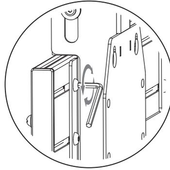
Lösen Sie die rückseitigen Schrauben und passen Sie den Abstand zwischen den Wandplatten entsprechend der VESA des Bildschirms an. Der Abstand muss **mindestens 400 mm** betragen.
