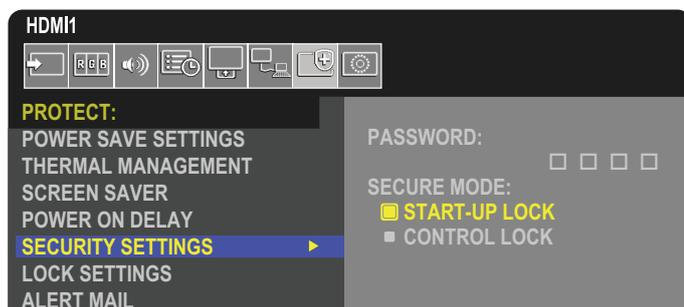
1. Navigieren Sie mit der Fernbedienung zu [SCHUTZ] und anschließend zu [SICHERHEITSEINST.].
