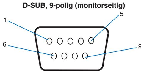
Dieser Monitor verwendet RXD-, TXD- und GND-Leitungen für die RS-232C-Steuerung.
