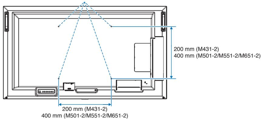
Montagezubehör kann an den Monitor angebracht werden, wenn dieser mit der Vorderseite nach unten liegt. Bevor Sie den Monitor mit der Vorderseite nach unten ablegen, legen Sie stets ein weiches Tuch auf den Tisch, z. B. eine Decke, die größer als der Monitor ist. So vermeiden Sie Kratzer auf dem LCD-Panel. Stellen Sie sicher, dass sich nichts auf dem Tisch befindet, was den Monitor beschädigen kann.
