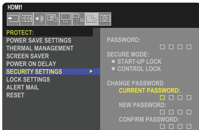
1. Navigieren Sie mit der Fernbedienung zu [SCHUTZ] und anschließend zu [SICHERHEITSEINST.].
