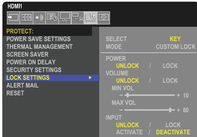
1. Navigieren Sie mit der Fernbedienung zu [SCHUTZ] und anschließend zu [SPERR EINSTELLUNGEN].
