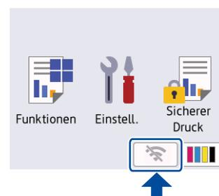
Wählen Sie die SSID (Netzwerkname) für Ihren Access Point/Router aus und geben Sie den Netzwerkschlüssel (Kennwort) ein. Wenn das Wireless-Setup erfolgreich war, wird auf dem Display [Verbunden] angezeigt.
