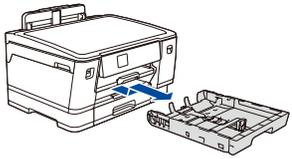
Ziehen Sie die Papierkassette vollständig aus dem Gerät, wie durch den Pfeil angegeben.
