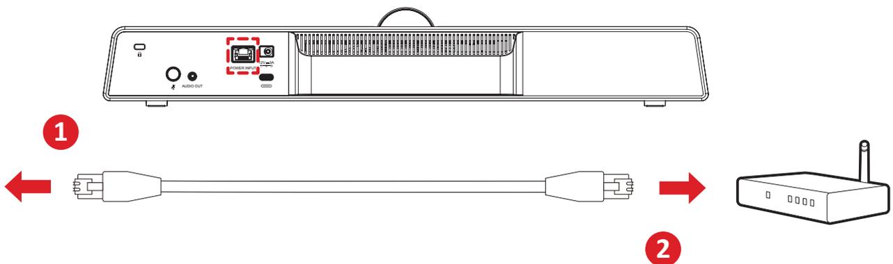
1. Schließen Sie das Ethernet-Kabel an den RJ45-Anschluss an der Rückseite der Kamera an.
