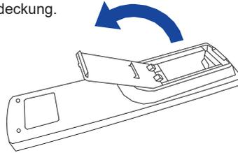
② Legen Sie die zwei AAA Batterien ein. Achten sie beim Einlegen auf die angezeigte Polarität in der Fernbedienung.
