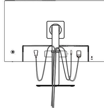
Rotieren Sie Satz (Drehpunkt) und stellen Sie Stecker. Es ist leicht, Stecker zu stellen und Kabel mit dem Kabelhalter zu verwalten.
