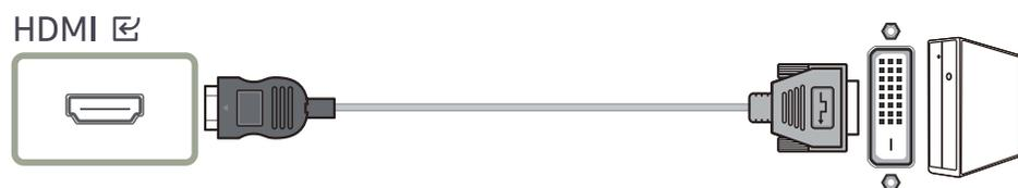
Die optimale Auflösung könnte bei einem HDMI/DVI-Kabel nicht verfügbar sein.
