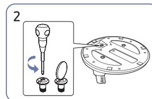
Lösen Sie die Befestigungsschraube an der Unterseite des Standfußes, um ihn abzunehmen.
