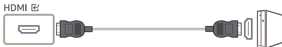
Verwenden Sie beim Anschließen eines HDMI-Kabels das Kabel, das Sie mit den Gerätekomponenten erhalten haben. Wenn Sie ein anderes als das von Samsung bereitgestellte HDMI-Kabel verwenden, kann sich die Bildqualität verschlechtern.
