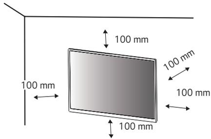
Um den Monitor an der Wand zu montieren, befestigen Sie die Wandhalterung (optional) an der Rückseite des Monitors.
