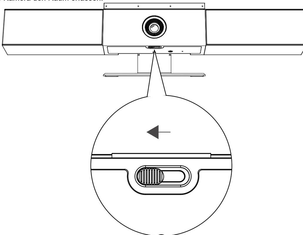
Schieben Sie den Hebel der Abdeckblende nach rechts, um die Abdeckblende zu schließen. Die Kamera wird ausgeschaltet.
