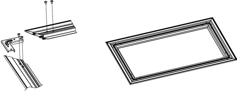
Beachten Sie vor dem Festziehen der Schrauben, dass die Rahmenteile möglichst perfekt ausgerichtet, ohne Spalten an den Ecken und absolut rechtwinklig verbunden wie ausgerichtet sind.
