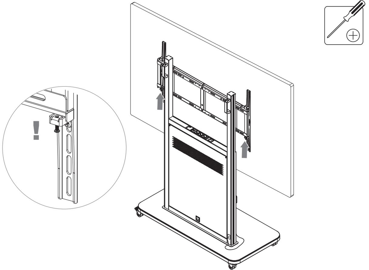
**8** Rückblende lösen und entnehmen | Loosen and remove the rear cover
