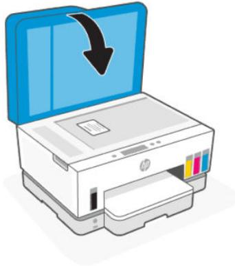
5. Öffnen Sie den Scannerdeckel, wenn Sie danach gefragt werden, drehen Sie die Karte um und halten Sie sich an die angezeigten Anweisungen, um die Seite zu drucken.
